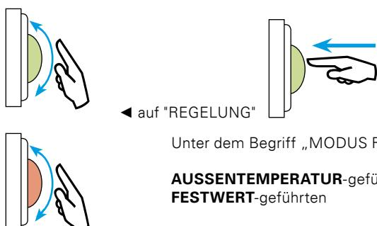
Unter dem Begriff „MODUS REGELUNG“ kann zwischen einer **AUSSENTEMPERATUR**-geführten oder einer **FESTWERT**-geführten Regelungsart gewählt werden.
