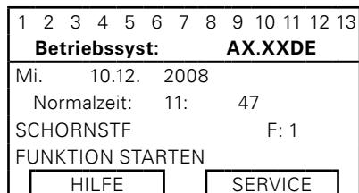
Wenn länger als 2 Minuten keine Betätigung/Einstellung/etc. am Regler erfolgt, wechselt die Displayanzeige automatisch in die Standardanzeige/Funktionsübersicht (Bedienebene für den Anwender).
