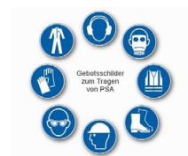
Panneaux d'obligation de porter un équipement de protection individuelle
