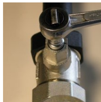
Écrou intérieur Desserrer à l'aide d'une clé à douille
